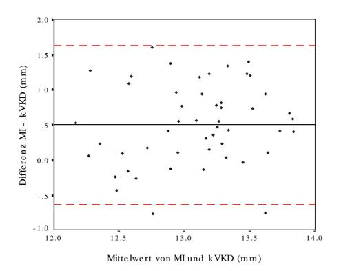
Abb 3.14: Übereinstimmung von MI und kVKD. Mittelwert = 0.5 mm, SD = 0.57 mm, Mittelwert + 2 SD = 1.64 mm, Mittelwert - 2 SD mm = -0.64 mm
