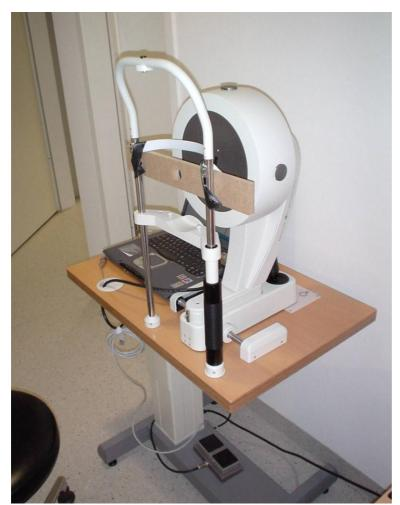
Abb. 1.11: Pentacam Scheimpflug-Kamera der Firma Oculus; mit Augenhalter
