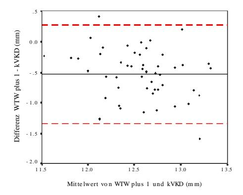
Abb. 3.12: Übereinstimmung von "WTW plus 1" und kVKD . Mittelwert = -0,53 mm, SD = 0,40 mm, Mittelwert + 2 SD = 0,27 mm, Mittelwert - 2 SD = -1,33 mm
