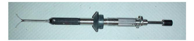
Abb. 2.1: Geuder VK-Messgerät nach Tetz mit partiell ausgeschobenen Messfüßchen
