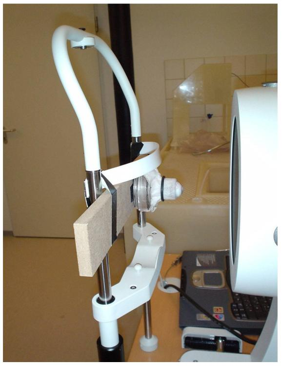
Abb. 2.4: Pentacam Scheimpflug-Kamera mit Fixierungsplatte und Augenhalter
