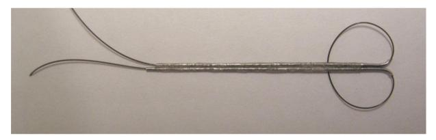
Abb. 4.3: Mechanisches Instrument zur Messung der Zirkumferenz der Vorderkammer
