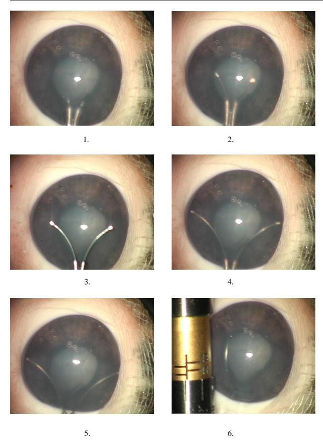
Abb. 2.5: Bildsequenz einer Messung des Vorderkammerdurchmessers im Schweineauge
