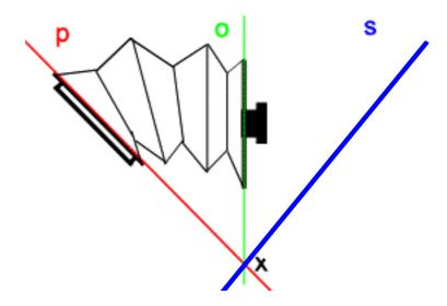
Abb. 1.10: Anordnung von Projektions (p)-, Objektiv (o)- und Objektebene (s) in einer Scheimpflugkamera
