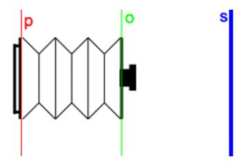
Abb. 1.9: Schematischer Aufbau einer Kamera mit Projektions- (p), Objektiv- (o) und Objektebene (s)
