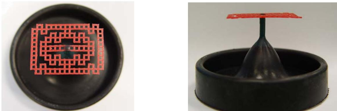
Abb.4.4: Links: Draufsicht Wachsgitter; Rechts: Seitenansicht angestiftetes Wachsgitter
