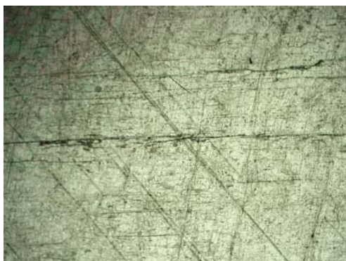
Abbildung 4.6: Mikroskopische Aufnahme der Probe Dolomit 1 mit gekreuzten Polarisatoren. Die Bildbreite entspricht ungefähr 2,5 mm.
