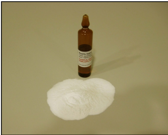
Abbildung 2: Komponenten des Knochenzementes BonOs ® : PMMA-Pulver und MMA-Flüssigkeit
