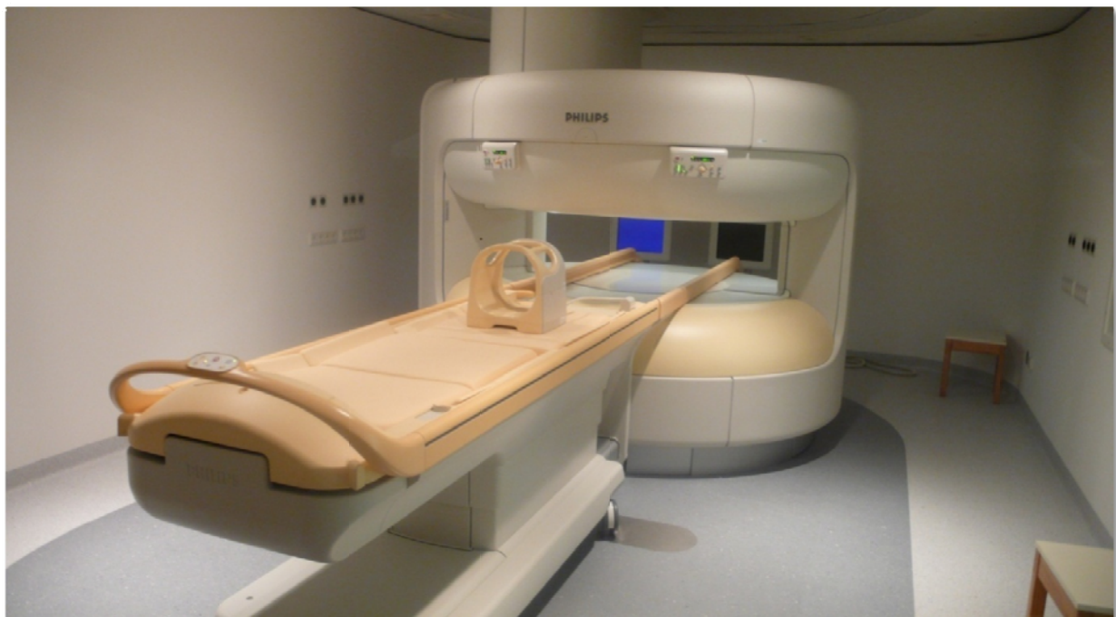
Abbildung 4: Offenes MRT Philips 1,0 T Panorama HFO mit Kopfspule und im Hintergrund Innenraummonitore auf denen das MR-Bild dargestellt werden kann
