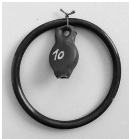
Abbildung 3.18 "i-Button" in Schrumpfschlauch
