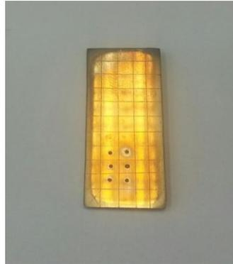
Abb. 2: gerastertes Gaudent S<sup>®</sup> -Legierungsplättchen nach elektrochemischer Belastung
