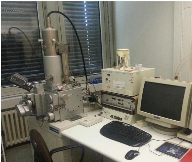
Abb. 6: Übersicht des Arbeitsplatzes für die REM/EDX-Messungen
