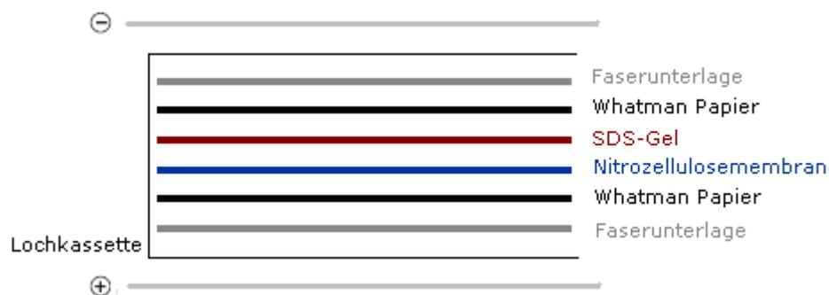
**Abb. 13: Reihenfolge der Materialien beim Tankblotting**
