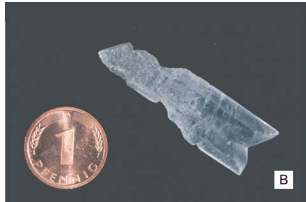
Abb. 8.2: A: Kern 4MC, Grobfraktion (>250µm), bestehend fast ausschliesslich aus elementarem S. B: Gipskristall aus Kern 8GK.
