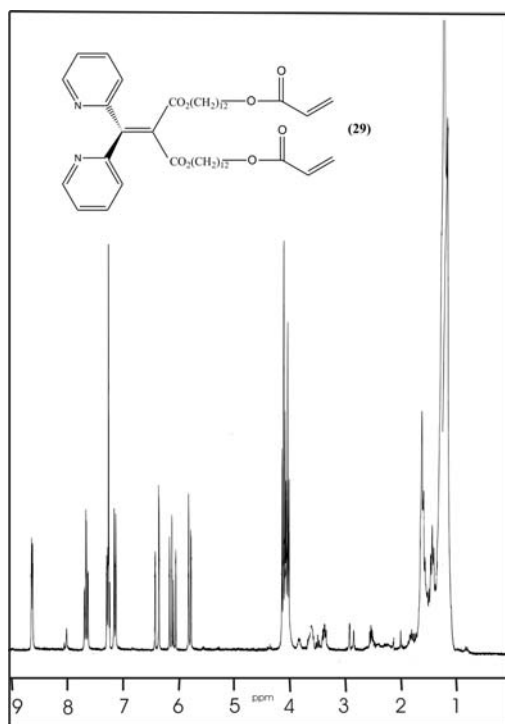
Abbildung 17: ^1\text{H-NMR} -Spektrum von Bis(2,2'-bipyridin)(di(acryloxycarbonyl-dodecyl)-di(pyridin-2-yl)methylenmalonat ( 29 )
