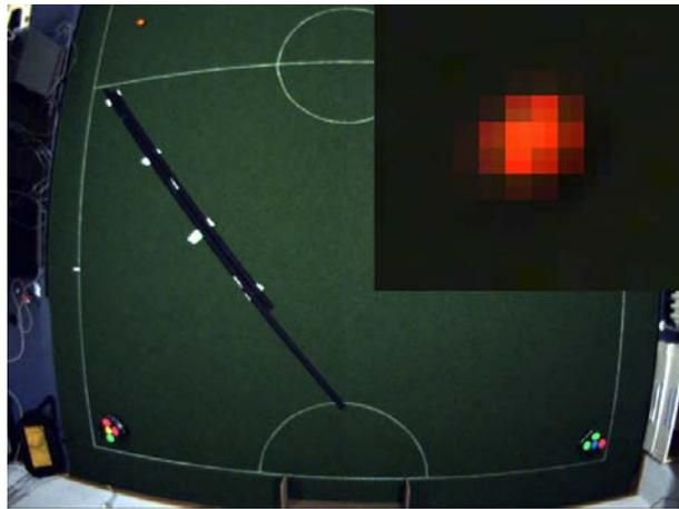
Abbildung 5.14: Der Versuchsaufbau zum Messen der Positionsgenauigkeit des Balls durch die Bildverarbeitung. Die schwarze Schiene links im Bild zwingt den Ball in eine feste Bahn. Rechts oben ist eine 1500% Vergrößerung des Balls zu sehen. Der Ausschnitt besteht aus  $22 \times 22$  Bildpunkten, das gesamte Bild aus  $780 \times 582$  Bildpunkten. Die Auflösung ist durch die Farbmaske noch einmal um ein viertel reduziert.
