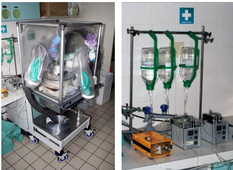
Abbildung 4.5: Isolator mit der Reaktionskammer (rechts) und Infusionsflaschen mit Medien und Schlauchpumpen (links)
