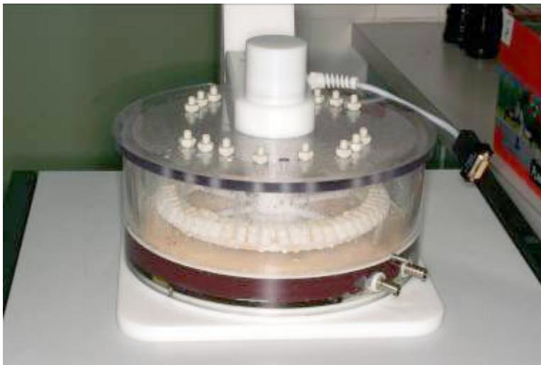
Abbildung 4.4: Reaktionskammer mit Probenrad und Proben
