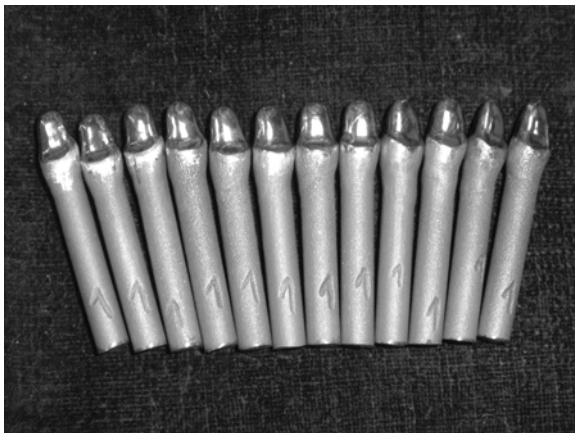
Abb. 12: Masteraufnehmer für VOSS-Versuch (Legierung: Wironit ® extrahart)
