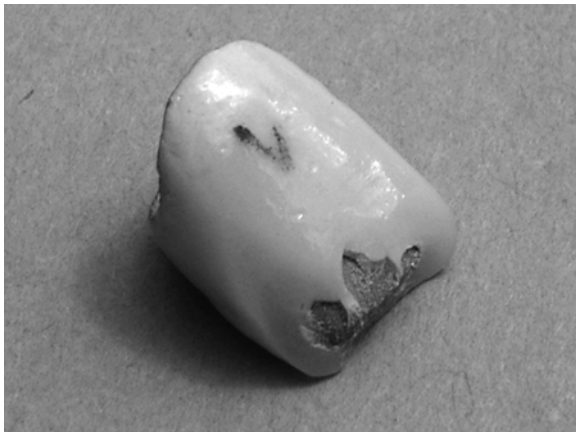
Abb. 21: Visuelle Begutachtung einer Krone nach erfolgtem VOSS-Versuch (Beispiel: BegoPal® 300)
