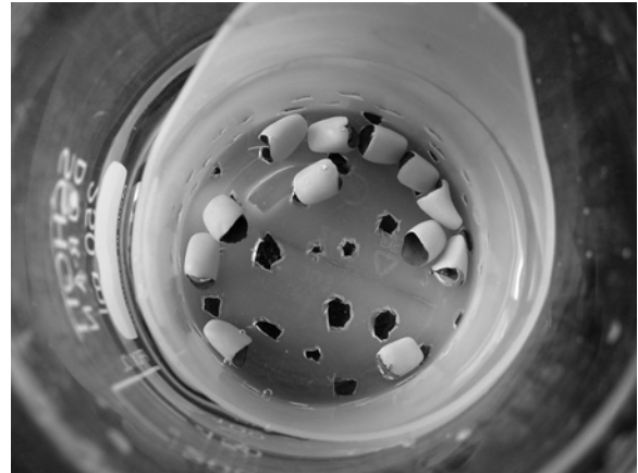
Abb. 17: Versuchskörper im Abschreckbad
