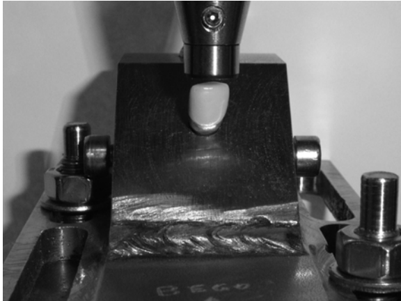
Abb. 14: Versuchsanordnung des VOSS-Versuchs (Beispiel: Wirobond® 280)
