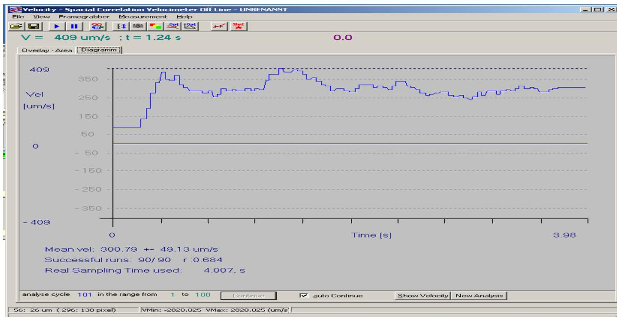
**Abbildung 6: Bestimmung der Erythrozytenflussgeschwindigkeit.** Dargestellt ist exemplarisch ein Beispiel für die Auswertung und Bestimmung der Erythrozytenflussgeschwindigkeit. Nach manueller Messung über dem Video ermittelte das Computerprogramm für den bestimmten Zeitraum die Messwerte. Unten links wird die ermittelte durchschnittliche Erythrozytenströmungsgeschwindigkeit angegeben und wie wahrscheinlich der berechnete Wert ist.
