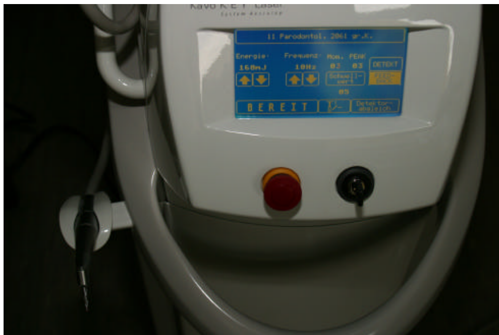
Bild 3: Ansicht des KaVo KEY@3 Lasers mit Touchdisplay und Handstück mit Lichtkeilansatz.
