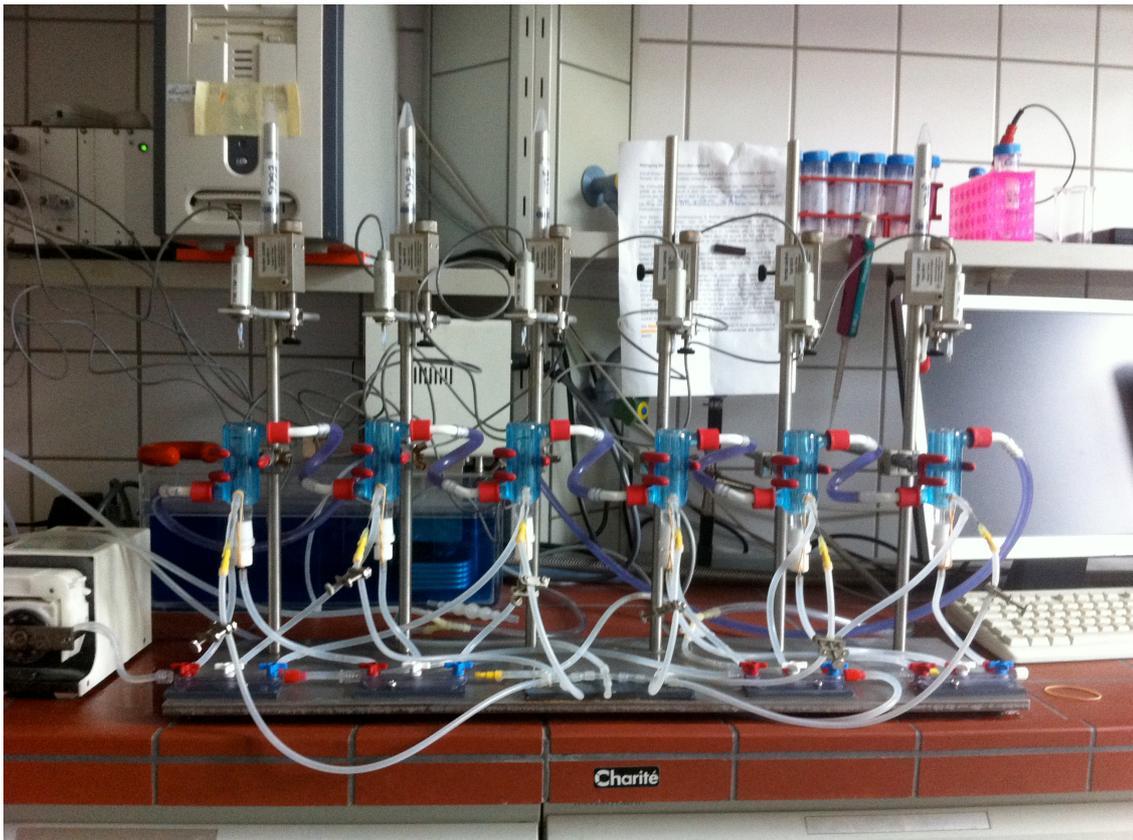
**Abb. 4.: Messanlage für Aortenringe im kardiologischen Forschungslabor (abgebildet sind 6 von 12 Messplätzen).**
