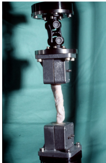
Abbildung 23: Einspanneinrichtung zur Messung der Torsionssteifigkeit.
