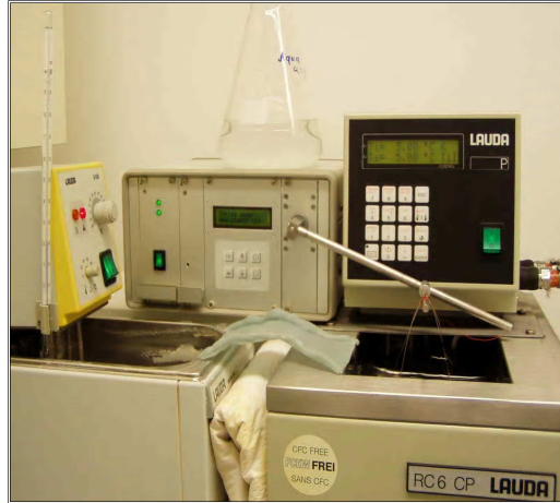
Abb. 8: Abbildung der Apparatur für die thermische Wechselbelastung. Der Schwenkarm positioniert die Zähne gerade im 5°C kalten Wasser.
