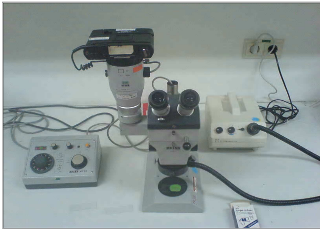
Abb. 13: Stereomikroskop mit separater Ringleuchte zur Begutachtung der Proben von apikaler Seite.
