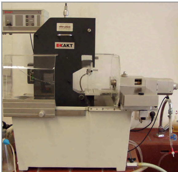
Abb.9: Exaktsäge mit Trennschleifsystem, Parallelführung und Vakuumpumpe zur feineingestellten Fixierung der eingebetteten Zähne auf dem Objektträger zur Probengewinnung.
