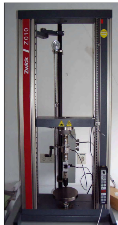
Abb.11: Universalprüfmaschine zur Bestimmung der Haftkräfte.
