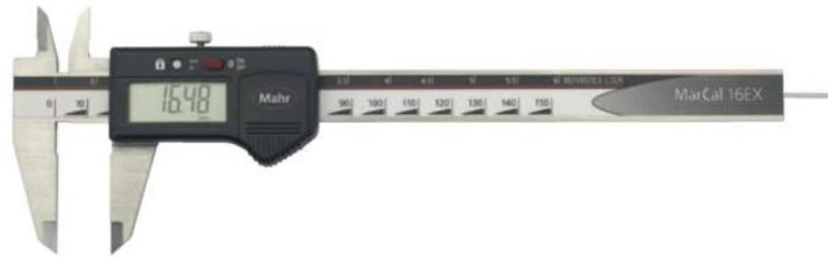
Abbildung 10: Elektronische Schieblehre Mahr, Typ 16EX
