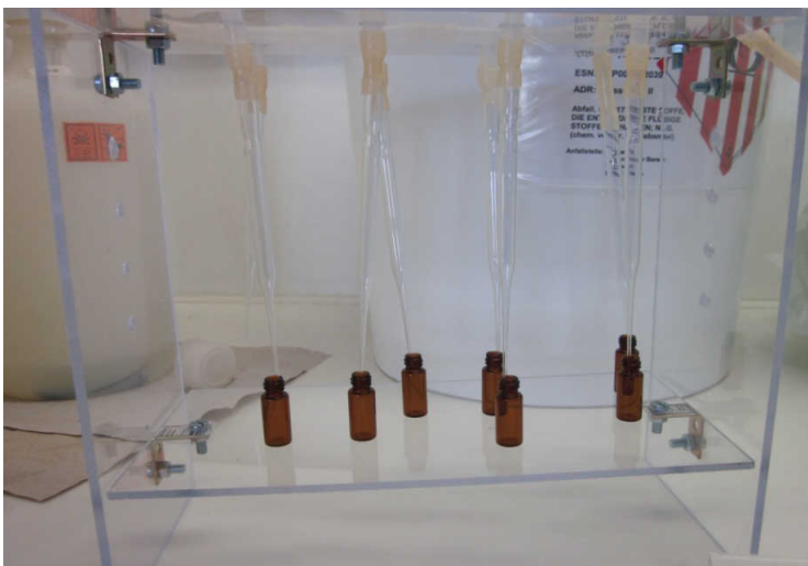
Abb. 11: Evaporation des Lösungsmittels mit reinem Stickstoff unter einem Laminarflow
