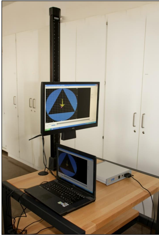
Abbildung 6: Messtisch mit Patientenmonitor zur visuellen Unterstützung des Patienten, Messverstärker für die Weiterverarbeitung und Laptop zur Speicherung der Messdaten
