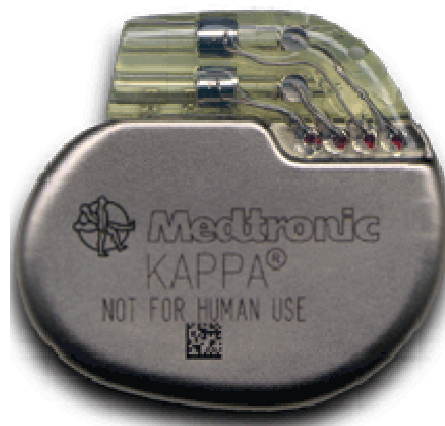
Abbildung 6: Schrittmacheraggregat vom Typ Medtronic Kappa (Demonstrationsmodell)
