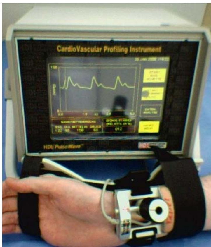
**Abbildung 2.** HDI/Pulsewave Research CardioVascular Profiling Instrument (Model CR-2000). Abgebildet ist das Messgerät und der am Handgelenk angebrachte Sensor. Die Blutdruckmanschette, die auch zum Gerät gehört, ist nicht abgebildet (Hypertension Diagnostics Inc, 1999).
