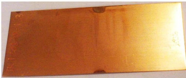
Abbildung 5.2-35: Mit einer Ätzrate von 50 nm/min in GndCl<sub>2</sub> EG geätztes Kupferblech.
