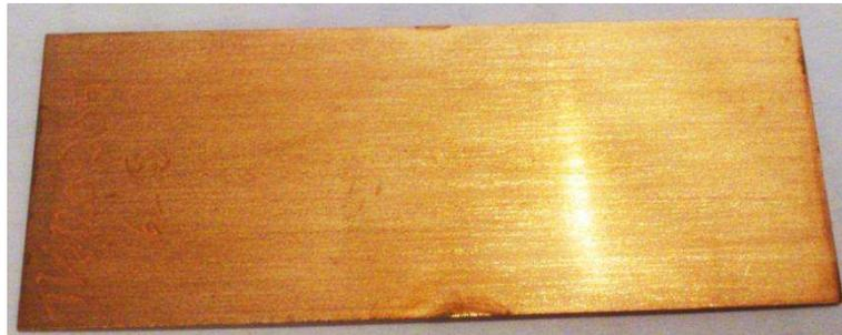
Abbildung 5.2-34: Mit einer Ätzrate von 470 nm/min in GndCl<sub>2</sub> EG geätztes Kupferblech.
