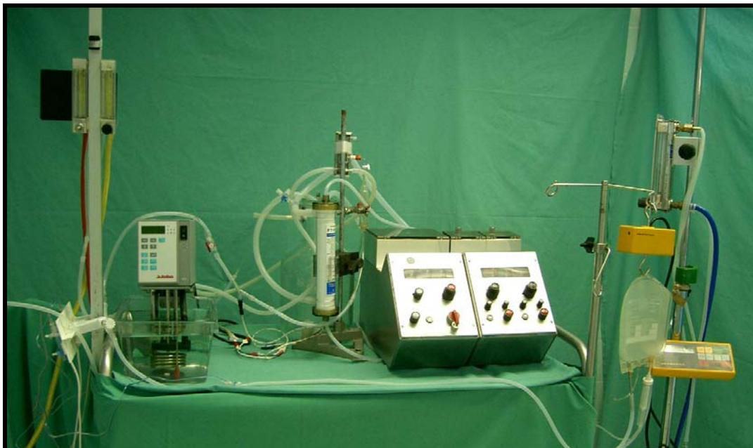
Abbildung 3b: Perfusionsaufbau mit Rollenpumpen, Organbad und Blutauflbereitungseinheit
