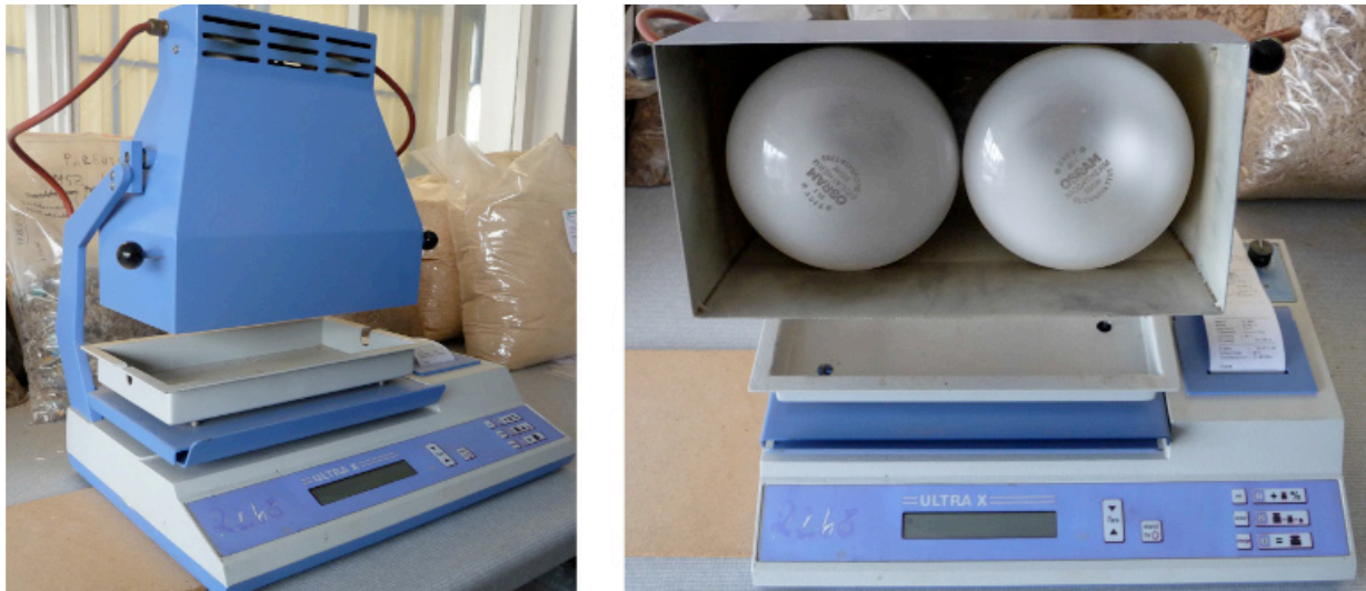
Abb. 12: Foto des Trocknungsgerätes Übersicht (links) und Sicht auf die beiden 250 W Glühbirnen zur Trocknung (rechts)
