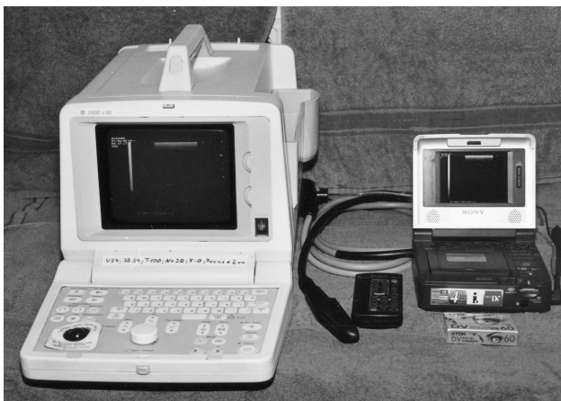
Abbildung 11: Aufbau des verwendeten Ultraschallgerätes mit angeschlossenem Aufzeichnungsgerät
