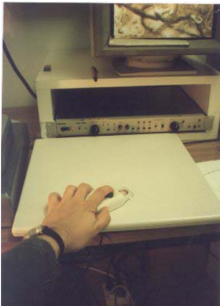
Abb. 17: Eine Digitalisierplatte mit entsprechender Maus erlaubt dem Untersucher die genaue Markierung der Interessenbereiche des Videobildes.
