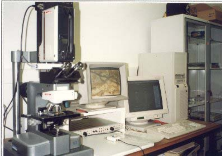
Abb.14: Lichtmikroskop, mit den Vergrößerungen von 8-fach bis 315-fach (E. Leitz, Wetzlar, Orthoplan)
