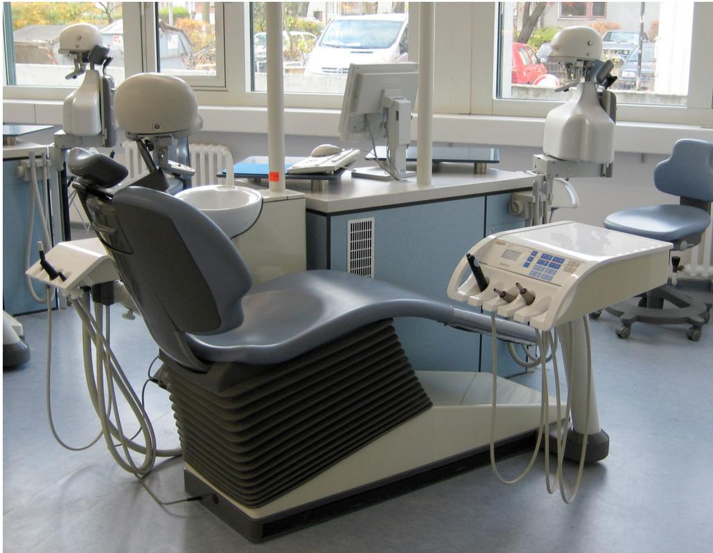
**Abb. 2-1: Simulationseinheit „Premium“, Baujahr 2003 (Typ C4<sup>+</sup>, Sirona Dental Systems GmbH) aus dem Phantomsaal der Zahnklinik Süd der Charité Berlin**
