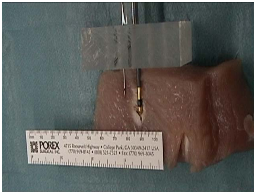
Abbildung 22: HFITT-Applikator, Thermoelement und Abstandhalter in Putenbrust. Gut sichtbare ellipsoide Koagulationszone.
