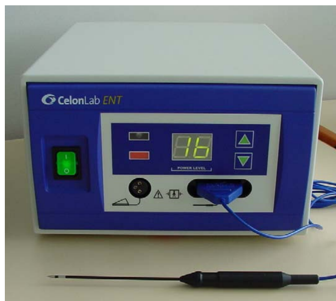
Abbildung 17: Hochfrequenzgenerator (CelonLab ENT)
