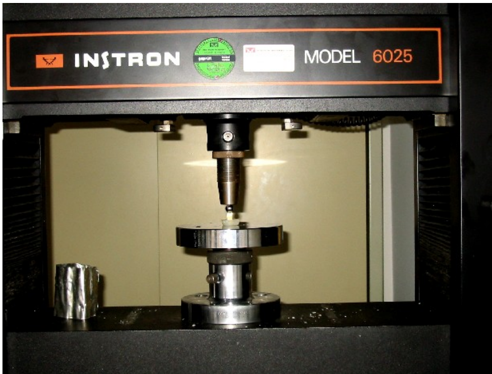
Abb. 3: Universalprüfmaschine vom Typ Instron 6025 mit Probekörper
