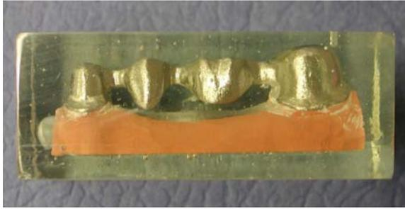
Abb. 10: Ansicht des eingebetteten Probekörpers für die Vorbereitung zur Herstellung von Schnitten für die Rand- und Zementspaltmessungen
