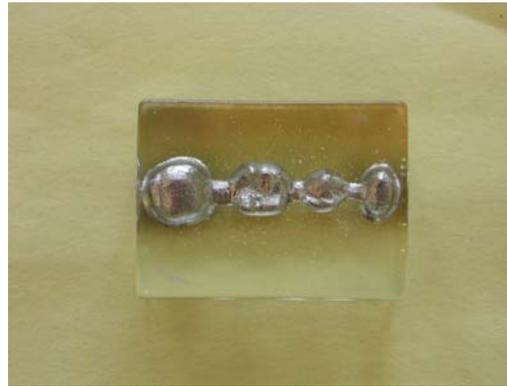
Abb. 18: Unterseite der in transparenten Kunststoff (Technovit) eingebetteten Brücke
