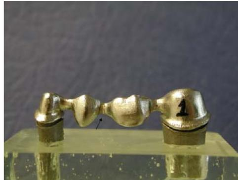
Abb. 23: Unzementiertes Brückengerüst vor der Belastung
