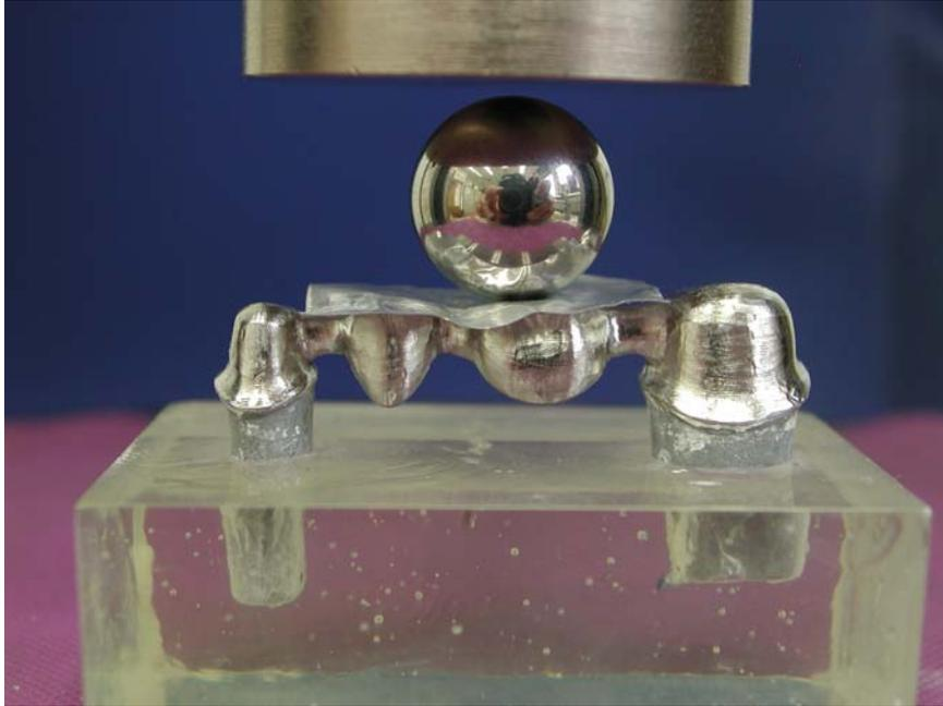
Abb. 25: Zementiertes Brückengerüst in der Prüfmaschine vor der Belastung
