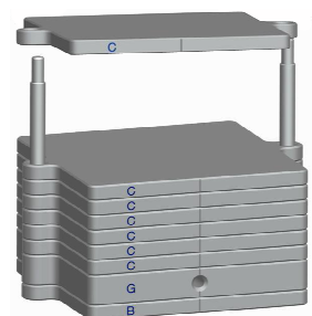
Abb. 37: Dosiswürfel aus Plexiglasplatten
