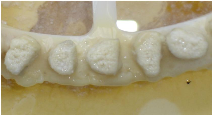
**Abbildung 5-1:** Aufsicht auf das Probenrad mit 5 Proben, die nach 18-tägiger Inkubation eine deutliche Plaquebildung aufwiesen.
