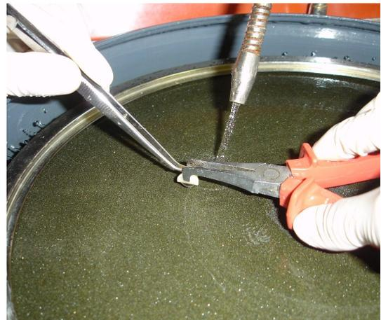
**Abb. 4-4-2:** Schleifen einer Zahnprobe
