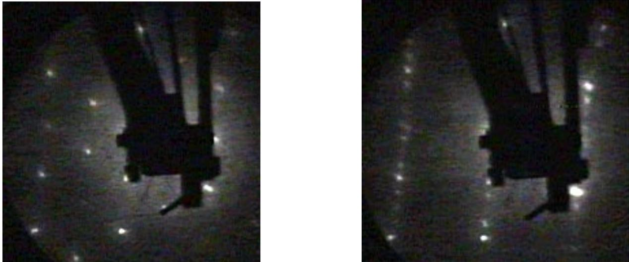
**Abb. 44:** *Beugungsbilder der Silber-c(2x2)-Struktur (links) und der (1x4)-Überstruktur (rechts) im Submonolagenbereich, Elektronenenergie 96 eV*
