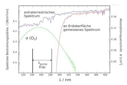
**Abbildung 1.2:** Extraterrestrische und terrestrische solare Bestrahlungsstärke sowie Absorptionsquerschnitt von Ozon (nach [CHo01, MMo86]). Im unteren Teil der Graphik ist der Bereich der in dieser Arbeit verwendeten Pumpwellenlängen  $\lambda_{pump}$  markiert.
