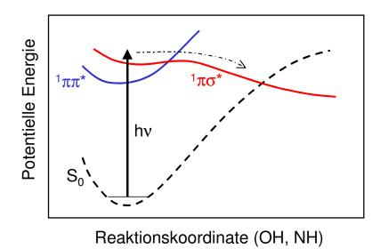
**Abbildung 1.3:** Schematische Darstellung der Kreuzung des repulsiven  ${}^{1}\pi\sigma^{*}$ -Zustands mit dem  ${}^{1}\pi\pi^{*}$ - und dem elektronischen Grundzustand (nach [SDo00b]).
