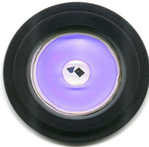
Abbildung 3.12: Zusammengebaute \text{CaF}_2 -Fenster im Metall-Probenhalter. Auf den \text{CaF}_2 -Trog wurde HR aufgetragen. Im Zentrum der Probe erkennt man das rechteckige Pinhole (rechts) und das Siliziumplättchen (links).
