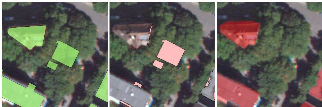
Abb. 72 Gebäudeklassifizierung, ALK, Differenzbild Gebäude-ALK
