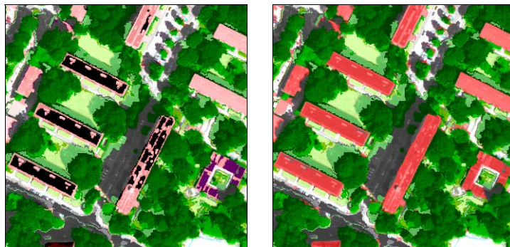
Abb. 52 Klassifizierungsergebnis für erhabene Objekte: Unterklassen in Inheritance-Darstellung, Elternklasse Semantic Elevated in Groups -Darstellung
