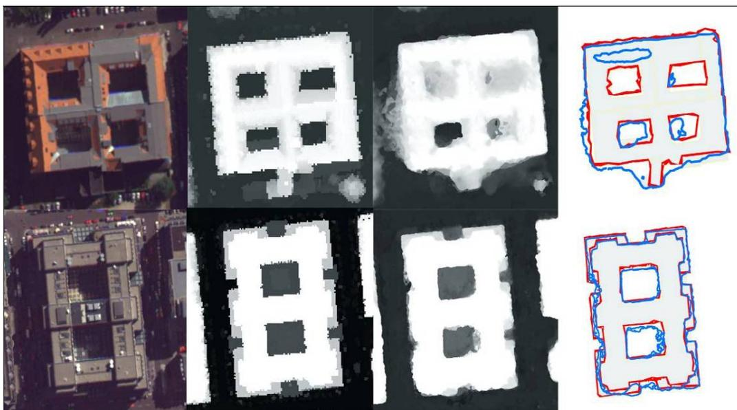
Abb. 28 Direkter Vergleich zwischen RGB, DOM-LIDAR (rot), DOM-HRSC (blau), generierter Kontur und ALK
