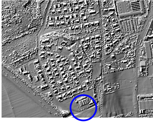
Abb. 19 Graustufenbild des ersten Echos, Ausschnittsvergrößerung (beleuchtet)
