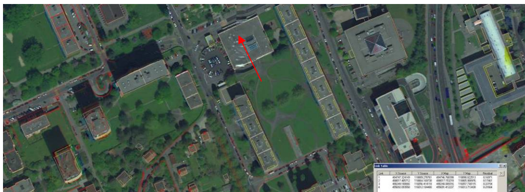
Abb. 10 Orthobild überlagert mit Vektoren und verbleibender Fehler (rot) nach Anwendung aller Korrekturen 26
