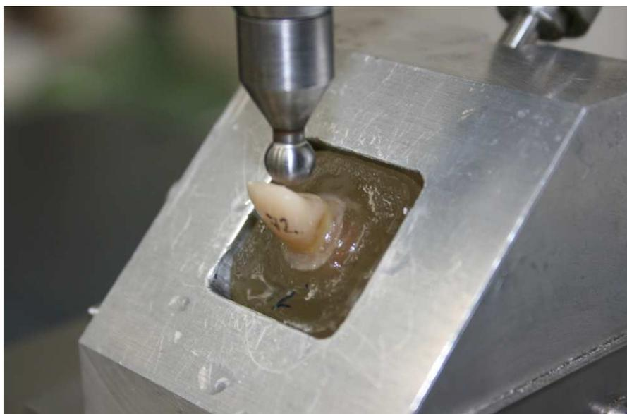
Abb. 10 Versuchsaufbau zur Bestimmung der Bruchlast. Die Belastung des oberen Schneidendrittels von palatinal erfolgte ausschließlich auf dem Aufbaumaterial.
