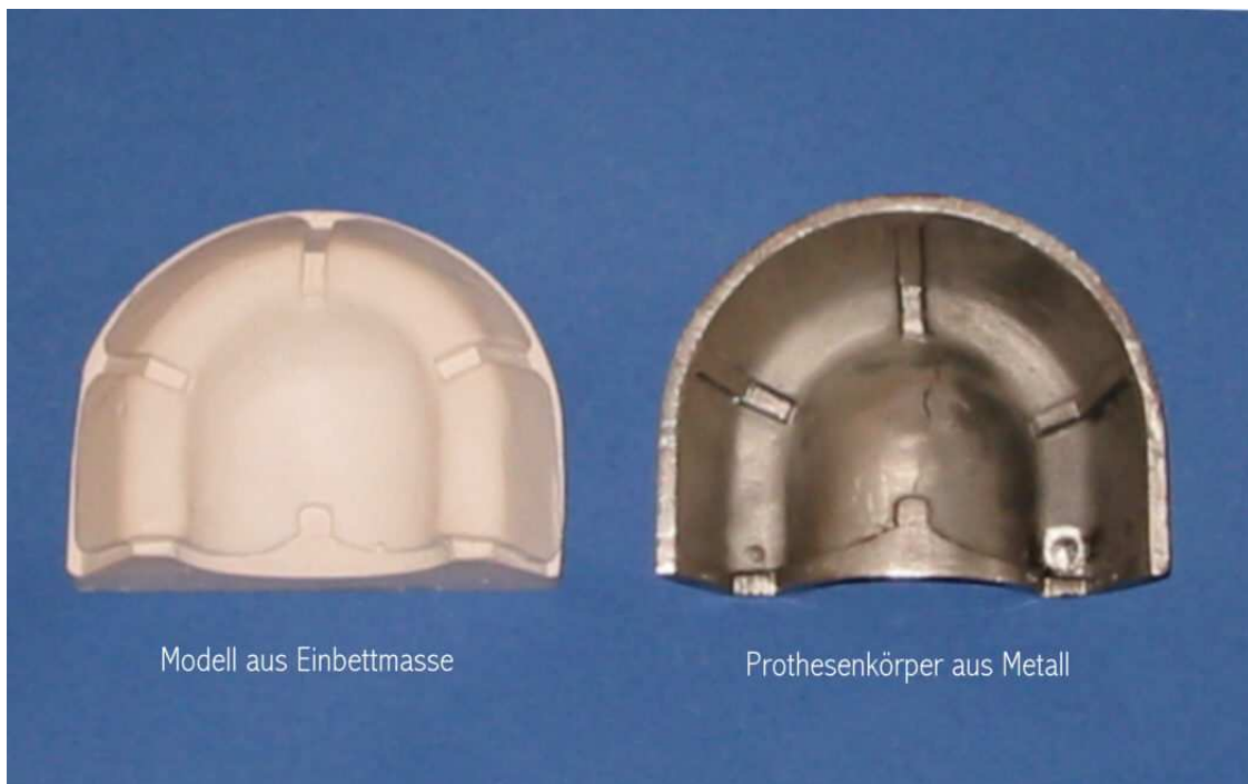
Abbildung 3.3.: Einbettmassenmodell und „Ur-Prothese“ (Innenseite)
