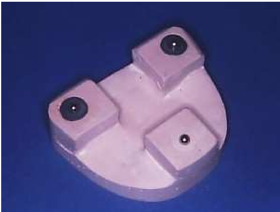
Abbildung 3.7.: Einrichtschlüssel für die Metallkugeln
