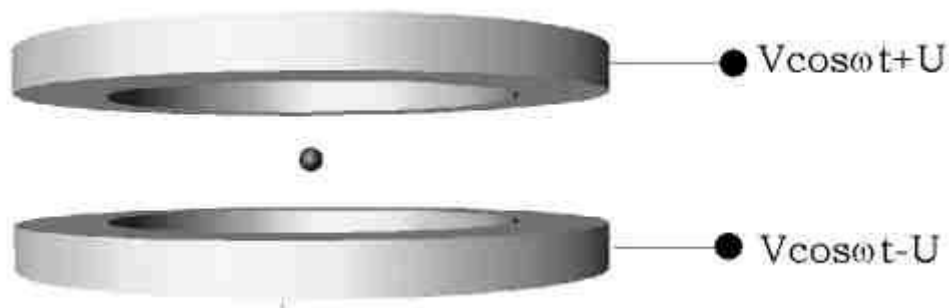
Abbildung 23: Schematische Darstellung der Ringelektroden mit den daran anliegenden Potenzialen [Zeichnung nach [Stöckel 2001]]
