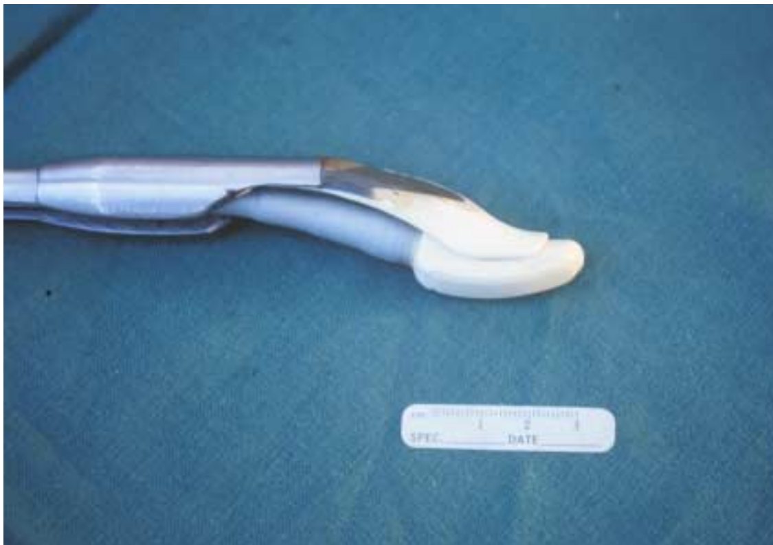
Abb. 5 Im Adapter fixierter 7,5 MHz Mikrokonvex-Schallkopf.
