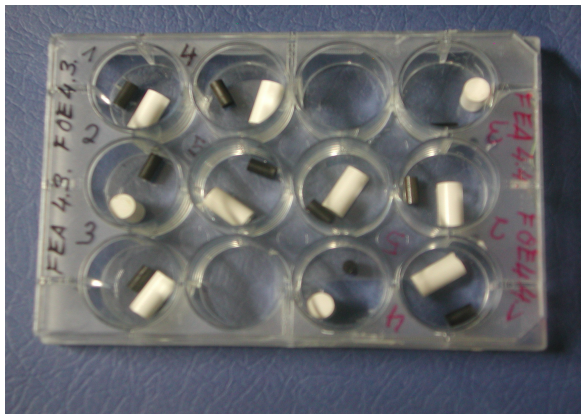
Abbildung 21: Wells mit Probekörpern vor Zugabe der Ringerlösung
