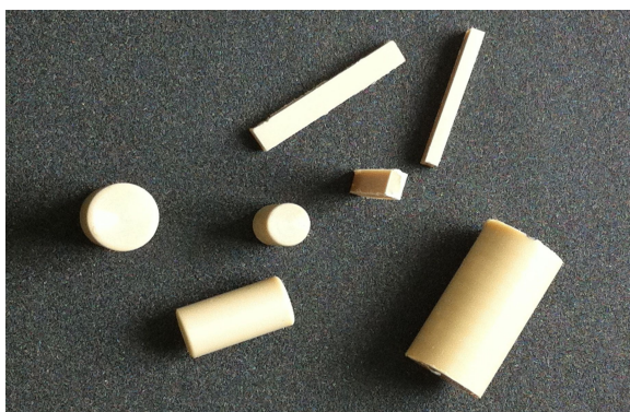
Abbildung 19: Prüfkörper (Bälkchen/ Zylinder) unterschiedlicher PEEK-Materialien
