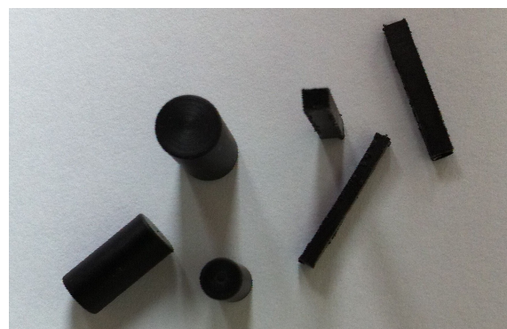
Abbildung 19: Prüfkörper (Bälkchen/ Zylinder) unterschiedlicher PEEK-Materialien
