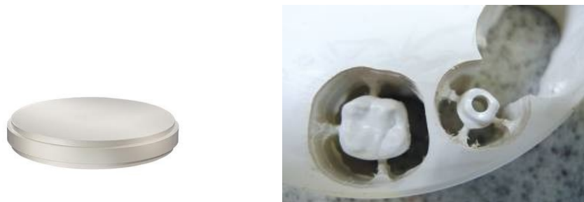
Abbildung 13: links: Rohling, rechts: vergrößerte Aufnahme nach Bearbeitung
