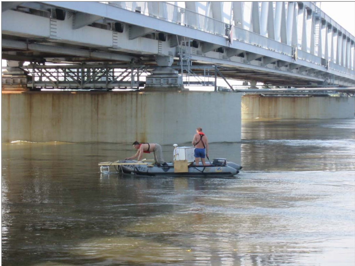
Abb. 4-2: Strömungsmessungen mittels eines am Bugausleger befestigten ADCP und eines mitloggenden DGPS während des Sommerhochwassers am 20. August 2002 unterhalb der Eisenbahnbrücke bei Wittenberge (EI-km 453,9), Foto: Damia Vericat
