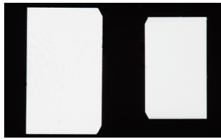
Abb. 12 IPS e.max ZirCAD Keramikscheibe - nach Fertigstellung und Politur. Jeweils vor und nach dem Sinterprozess dargestellt.
