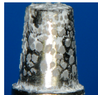
adhäsiv/kohäsives Zementversagen am Aufbau (Klasse 2)
