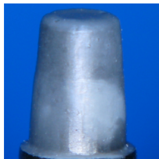
adhäsives Zementversagen an der Krone (Klasse 5)
