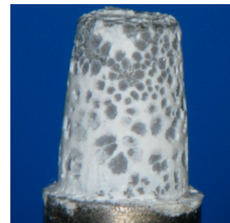
adhäsiv/kohäsives Zementversagen an der Krone (Klasse 4)
