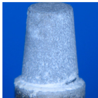
überwiegend kohäsives Zementversagen (Klasse 3)
