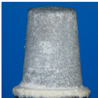
überwiegend kohäsives Zementversagen (Klasse 3)
