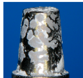
adhäsiv/kohäsives Zementversagen am Aufbau (Klasse 2)
