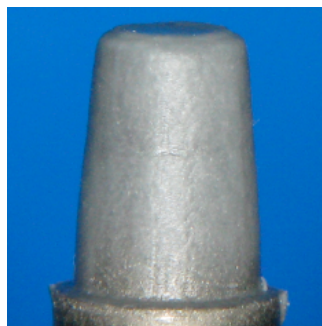
adhäsives Zementversagen an der Krone (Klasse 5)
