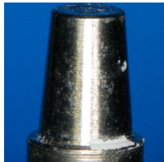
adhäsives Zementversagen am Aufbau (Klasse 1)
