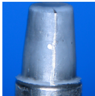
adhäsives Zementversagen an der Krone (Klasse 5)
