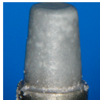
adhäsives Zementver- sagen an der Krone (Klasse 5)
