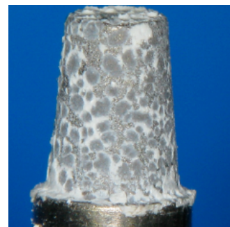
überwiegend kohäsives Zementversagen (Klasse 3)
