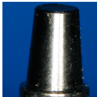
adhäsives Zementversagen am Aufbau (Klasse 1)
