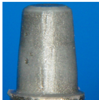
adhäsives Zementver- sagen an der Krone (Klasse 5)
