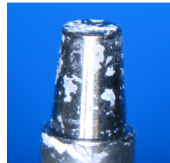
adhäsiv/kohäsives Zementversagen am Aufbau (Klasse 2)
