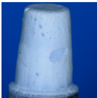
adhäsives Zementversagen an der Krone (Klasse 5)
