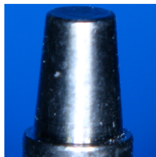
adhäsives Zementversagen am Aufbau (Klasse 1)
