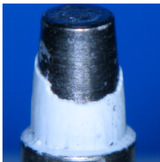
adhäsives Zementversagen an Gerüst und Krone (Klasse 6)
