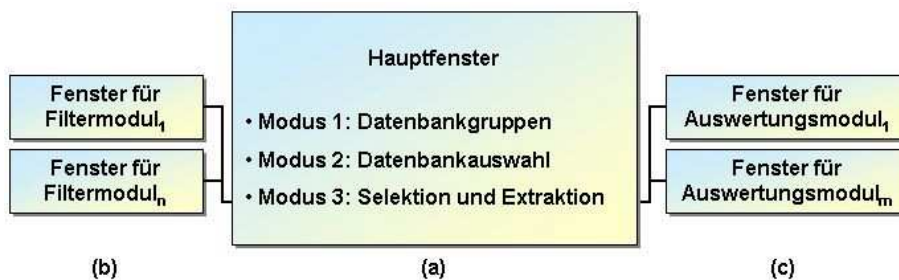
Abb. 19.1 - Schematische Darstellung der Fensterstruktur des Client: Ausgehend vom Hauptfenster (a) erfolgt der Zugriff auf die Fenster der Filtermodule (b); zur Darstellung von Anfrageergebnissen werden die Fenster der entsprechenden Auswertungsmodule geöffnet (c).
