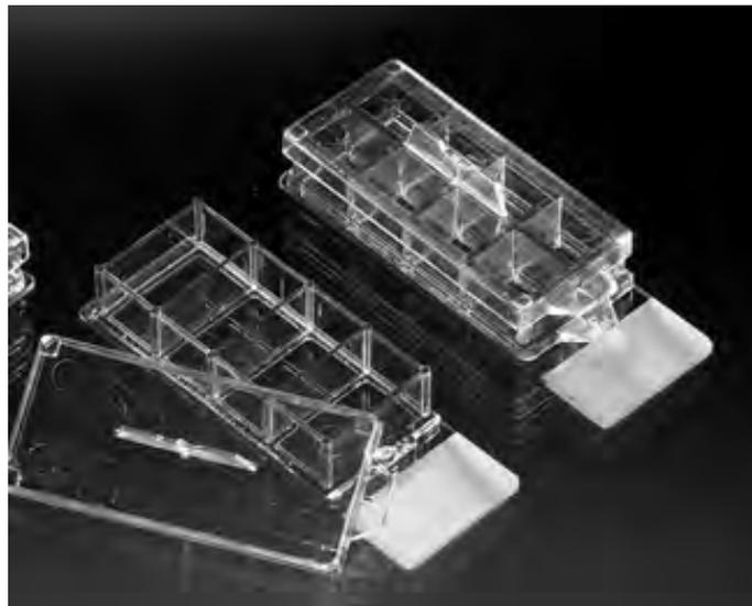
Abbildung 4: Nunc Kammerdeckgläser, Kammerstruktur entfernbare
