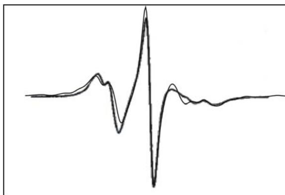
Abbildung 6.16. ESR-Spektrum der Spinsonde an Position 72R1 aus experimentellen Ergebnissen (fette Linie) im Vergleich zur Simulation (schmale Linie) für den Direktor als Mittelwert der Verteilung mit
