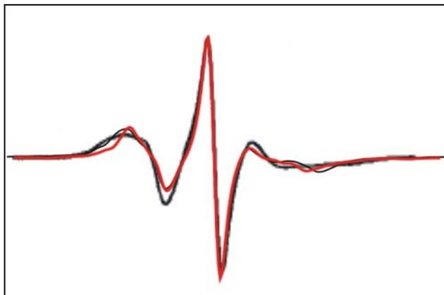
**Abbildung 6.23.** ESR-Spektrum der Spinsonde an Position 65R1 aus experimentellen Ergebnissen (fette Linie) im Vergleich zur Simulation (schmale Linie) für den Direktor als Mittelwert der Verteilung mit  $\beta_D = 0^\circ$  und  $D = 1.7 * 10^8 \text{ s}^{-1}$  (schwarz) bzw.  $D = 2.0 * 10^8 \text{ s}^{-1}$  (rot). Die Scanbreite der experimentellen Daten beträgt 98G, die Feldmodulationsamplitude 1G. Die angepasste Linienbreite betrug  $T_2^{-1} = 4.5G$ .
